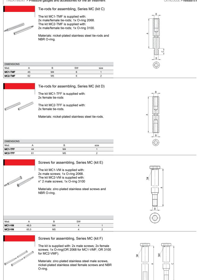
DIMENSIONS в С D SW SW1 Mod Α size MC1-VMF M4 48,5 M4 42,5 4 4 1 MC2-VMF 65,5 M5 59,5 M5 4 4 2
